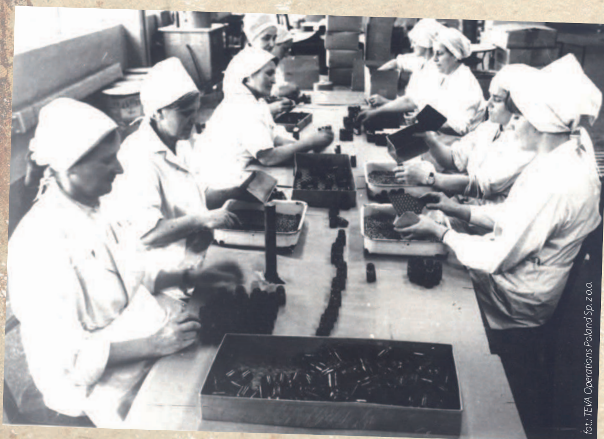
Produkcja zastrzyków w ampułkach - nalewanie płynu i zatapianie ampułek – lata 50. XX w.
