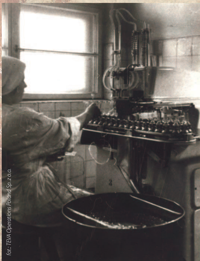
Produkcja zastrzyków w ampułkach - nalewanie płynu i zatapianie ampułek – lata 50. XX w.
