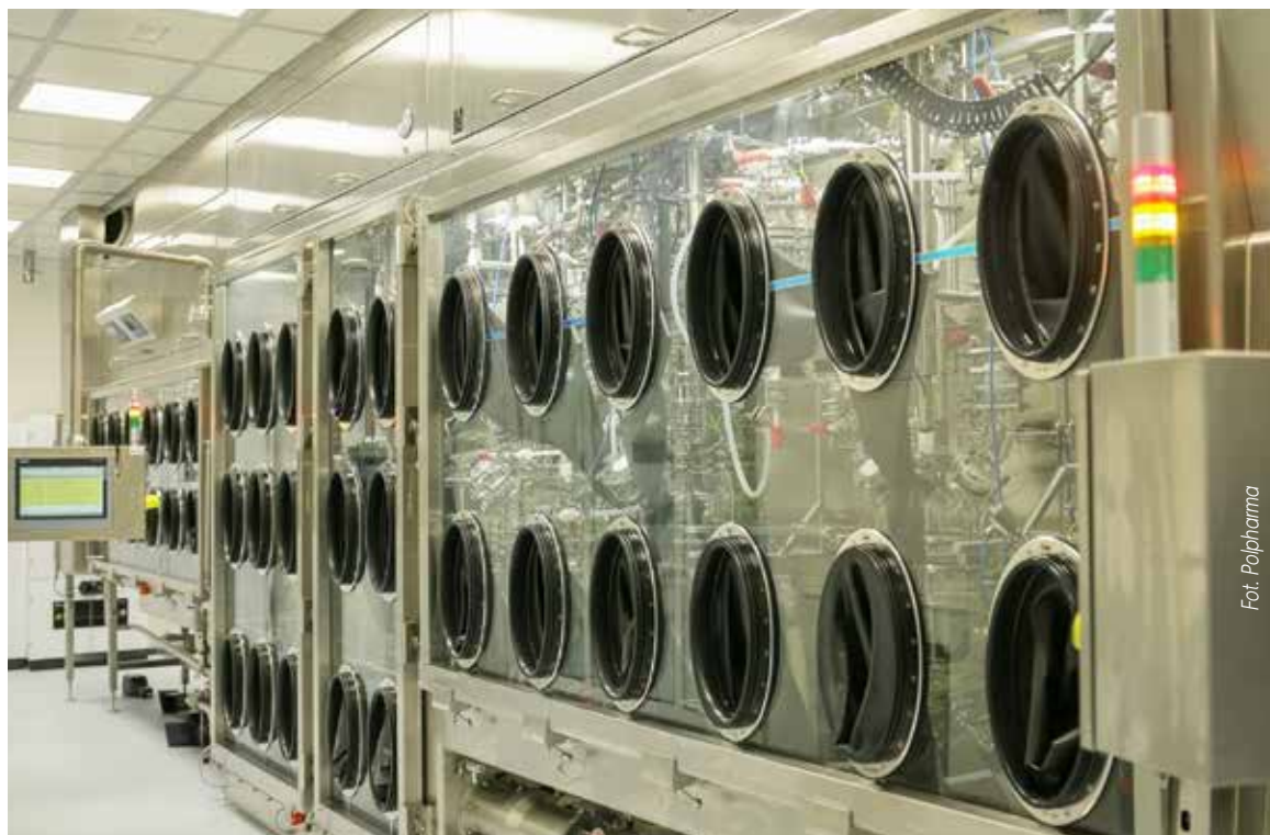
FOT. 1 Izolator służący do wytwarzania HPAPI w skali kilogramowej [1]
